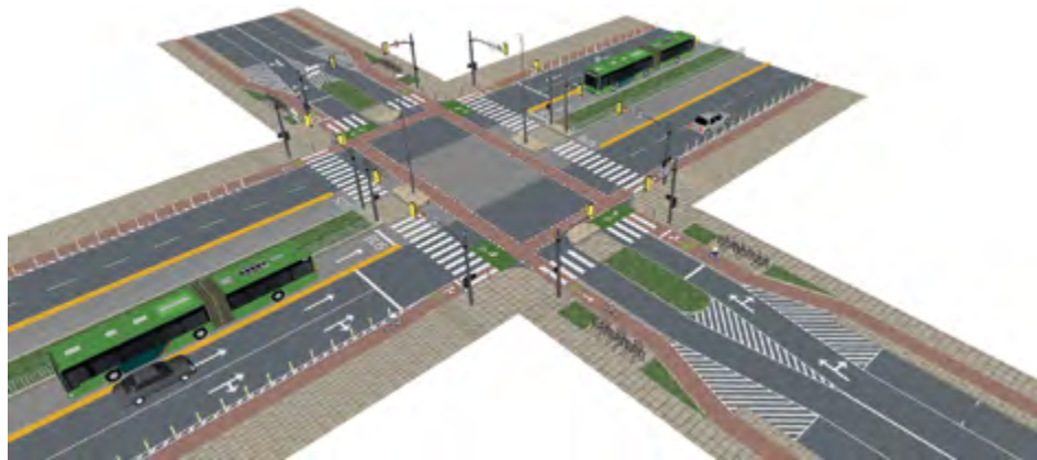
Via arterial com canteiro central, restrição de conversão à esquerda e faixa de ônibus exclusiva
