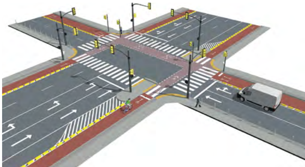
Ciclovias separadas do tráfego veicular através de uma barreira física
