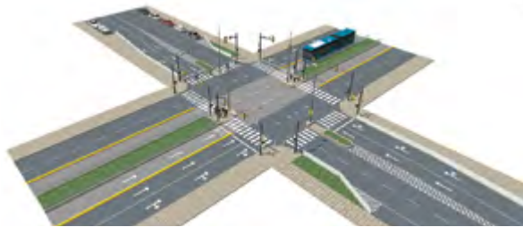
Interseção de quatro aproximações com corredor de ônibus junto ao canteiro central
