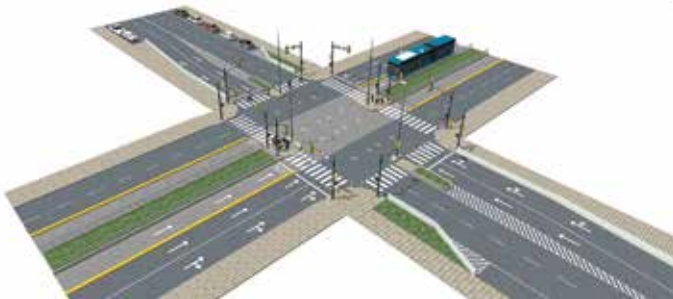
Intersección de cuatro ramales con carriles para autobuses en medio de la vía.
