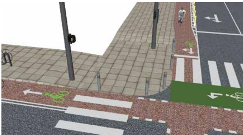
Una intersección que mejora la visibilidad de los conductores y ciclistas que se acercan con un recuadro para bicicletas que permite a los ciclistas los conflictos en los puntos de giro.
