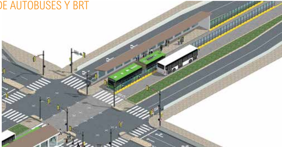
Acceso peatonal a una estación de autobuses de tránsito rápido (BRT) en carriles centrales.
