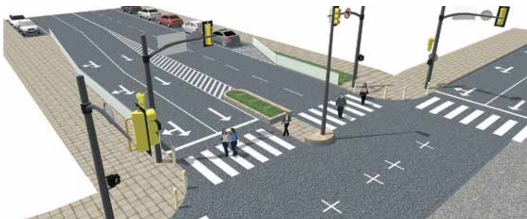
Refugio peatonal sin mediana continua.
