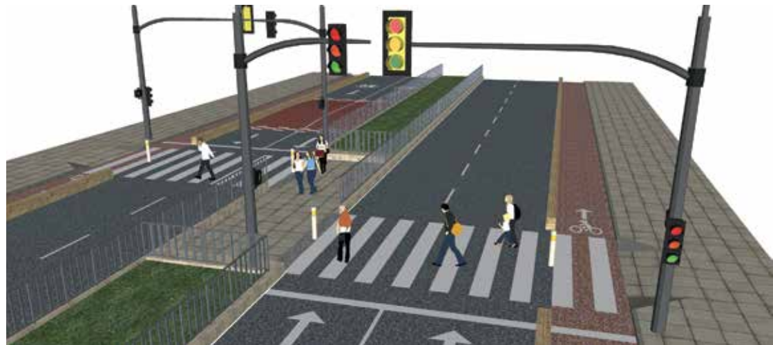
Mediana con espacio para peatones en una vía de cuatro carriles; diseño aplicable a vías de dos carriles.
