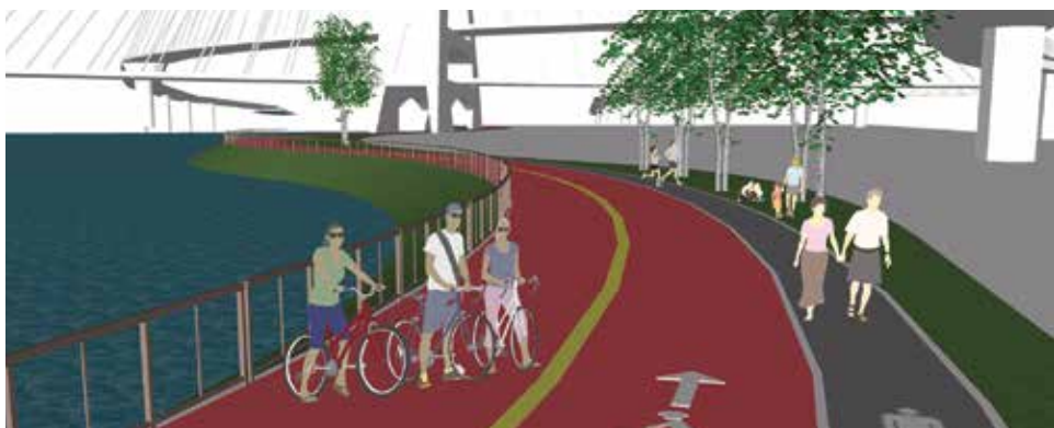
Sendero independiente que segrega a ciclistas de peatones para reducir conflictos.
