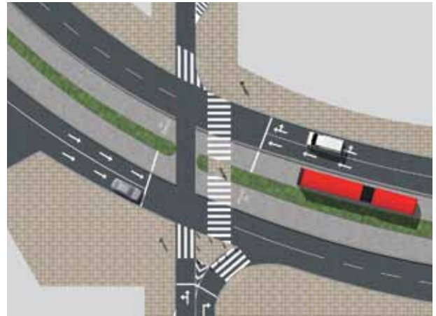
Hình 4.2.2 | Thiết kế lối sang đường trước và sau, tạo lối đi thẳng và ngắn hơn
