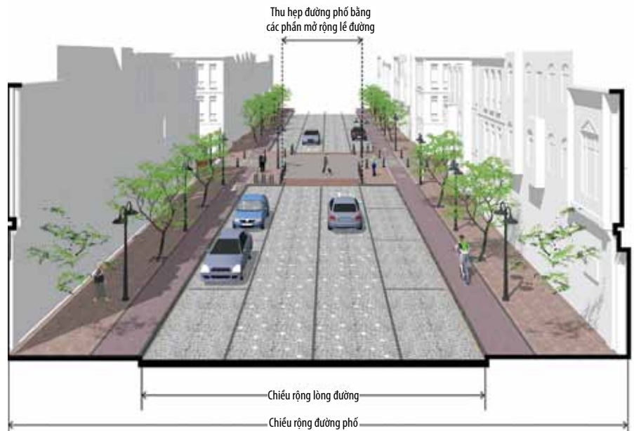
Minh họa sau cho thấy những khía cạnh khác nhau của chiều rộng đường phố.
