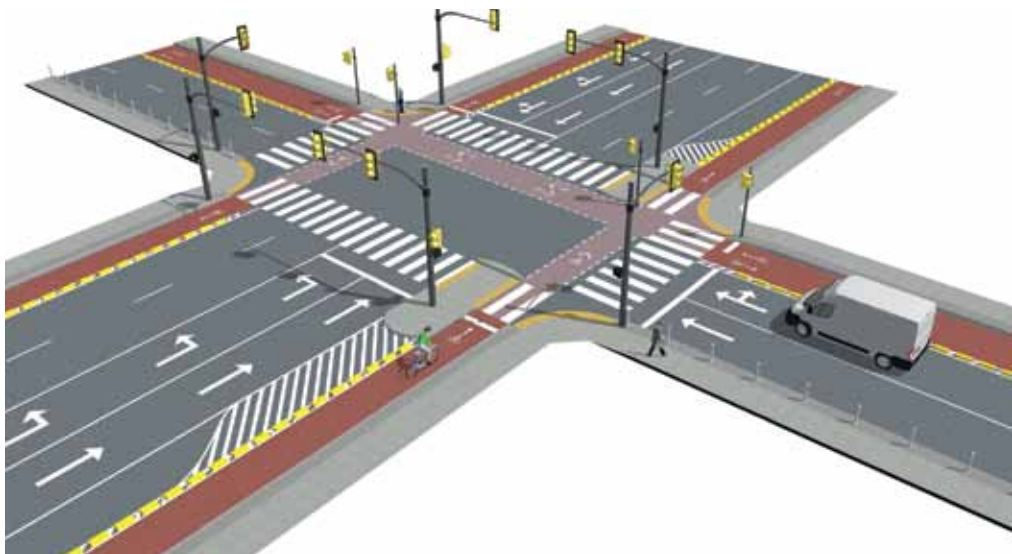
Đường dành cho xe đạp được tách riêng với giao thông ô tô bằng hàng rào vật lý.
