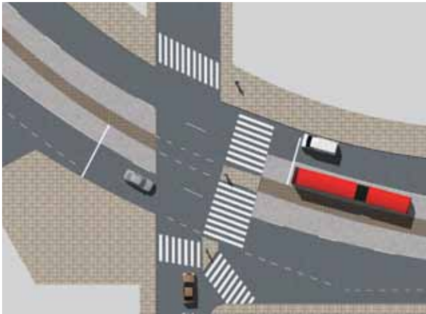
Hình 4.2.2 | Thiết kế lối sang đường trước và sau, tạo lối đi thẳng và ngắn hơn
