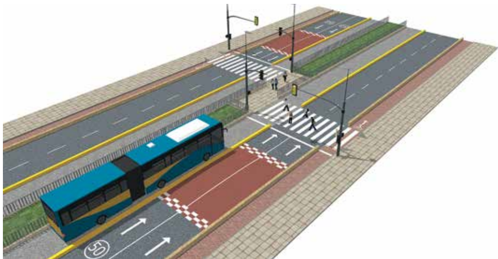
城市主干道上的街区中段人行横道
