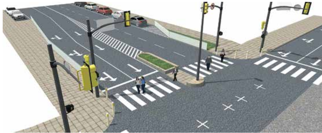
没有连续隔离带的中央隔离安全岛
