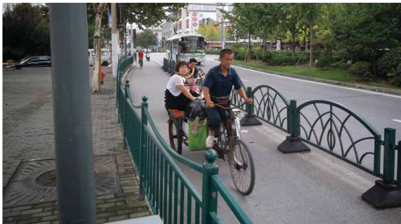
上：墨西哥城的一条单向自行车径利用物理障碍保护骑车者，并在机动车驶入处移除障碍，画上标线。 下：上海的自行车基础设施，通过护栏将骑车者与机动车隔离，同时防止行人入内。
