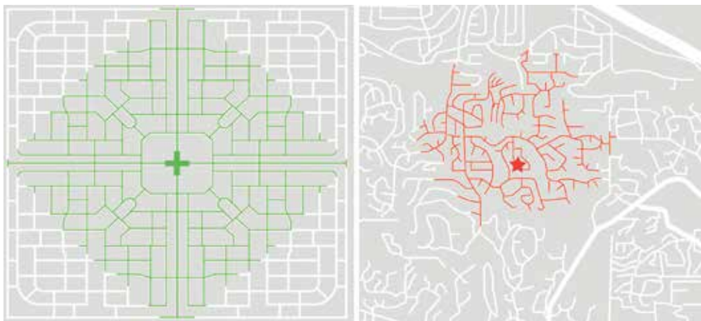
不同街道连通性情景下800米步行半径可达范围(紧凑型网格与蔓延式郊区对比)。
