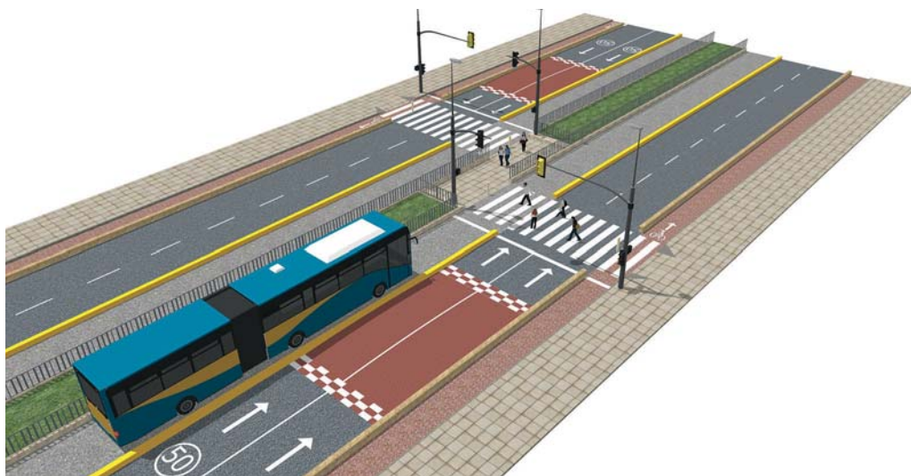
ทางข้ามบนช่วงถนนระหว่างแยกบนถนนสายหลักในชุมชนเมือง
