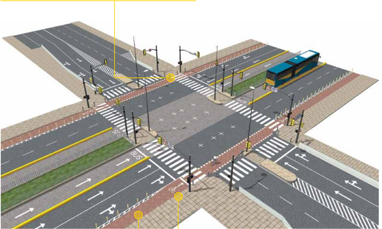
Şekil 31 Üzerinde bisiklet yolu bulunan kavşaklar
