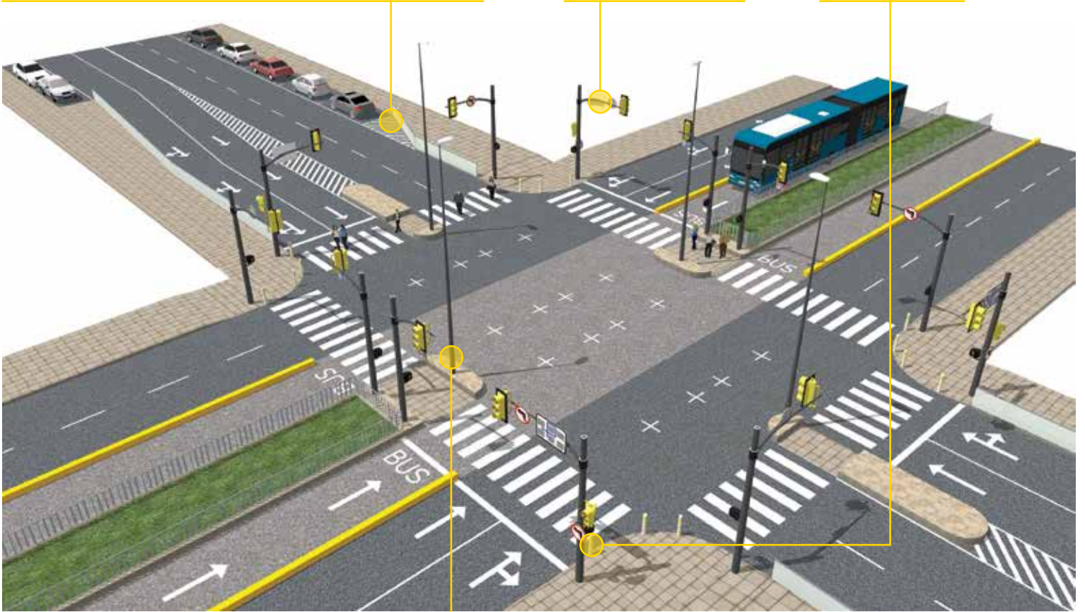
Şekil 27 Dört yönlü, sola dönüşü bulunmayan bir kavşak
