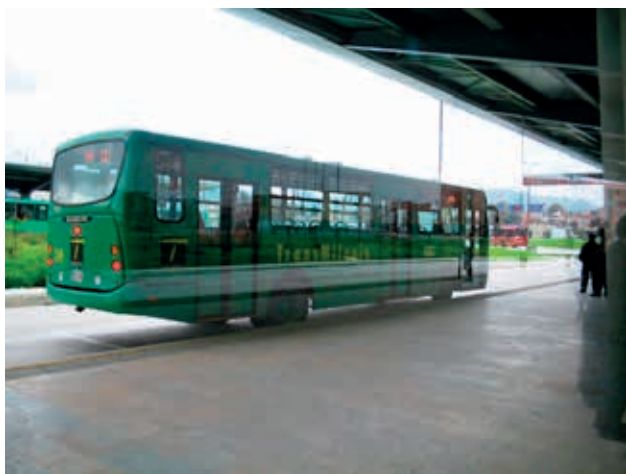
Рисунок 78 Изображения, показывающие типичную конструкцию терминала системы БРТ «TransMilenio». Слева: зеленые подвозящие автобусы останавливаются на левой стороне платформы. Справа: красный сочлененный магистральный автобус останавливается с правой стороны той же платформы
