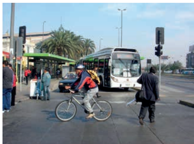
Рисунок 63 Автобус маневрирует для объезда автомобиля, остановившегося перед остановочным комплексом с боковым размещением в системе «Transantiago», г. Сантьяго-де-Чили
