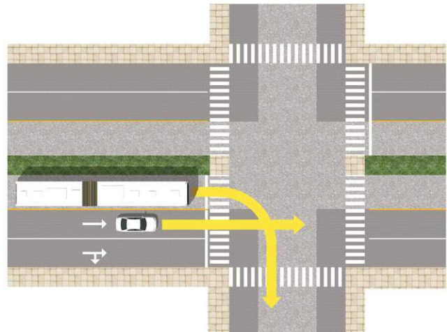
Figura 73 Diagrama de acidentes ilustrando o potencial conflito entre ônibus que fazem conversão à direita e veículos que continuam em frente. Esse tipo de acidente tem sido reportado no TransMilenio.
