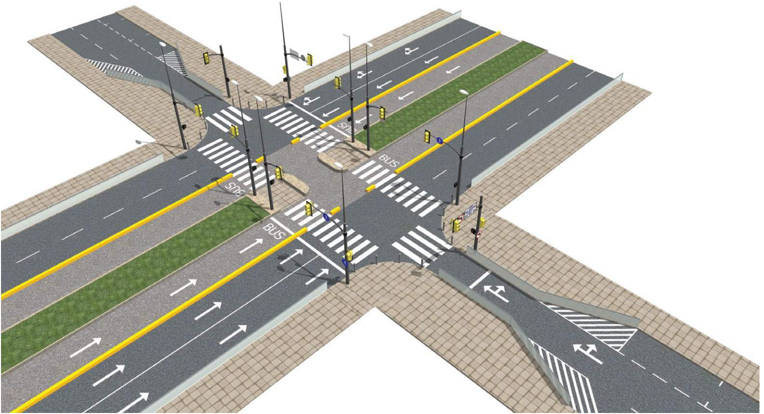
Figura 33 Interseção entre via principal e via secundária
