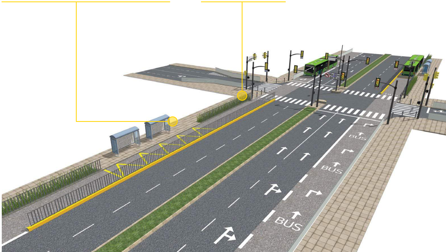
Figura 63 Estações junto ao meio-fio
