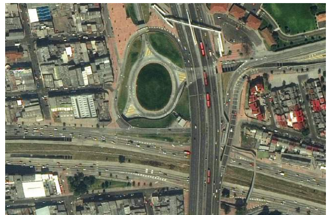
Figura 74 Interseção entre três corredores TransMilenio: NQS, Calle 80 e Avenida Suba. As conexões de ônibus entre os três corredores são feitas via passarelas e passagens subterrâneas que maximizam a capacidade de todos os movimentos e minimizam os conflitos potenciais entre os ônibus.
