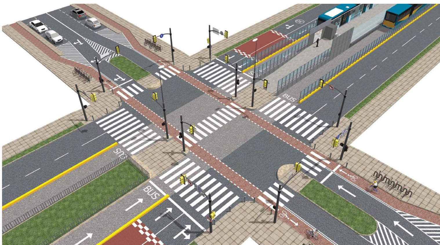
Figura 82 Integração com infraestrutura cicloviária
