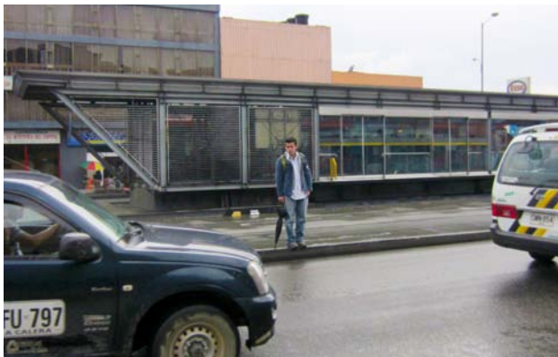
Hình 52 Người đi bộ đi qua đường ngay phía trước một bến không có hàng rào giữa làn xe buýt và làn đường giao thông hỗn hợp.
