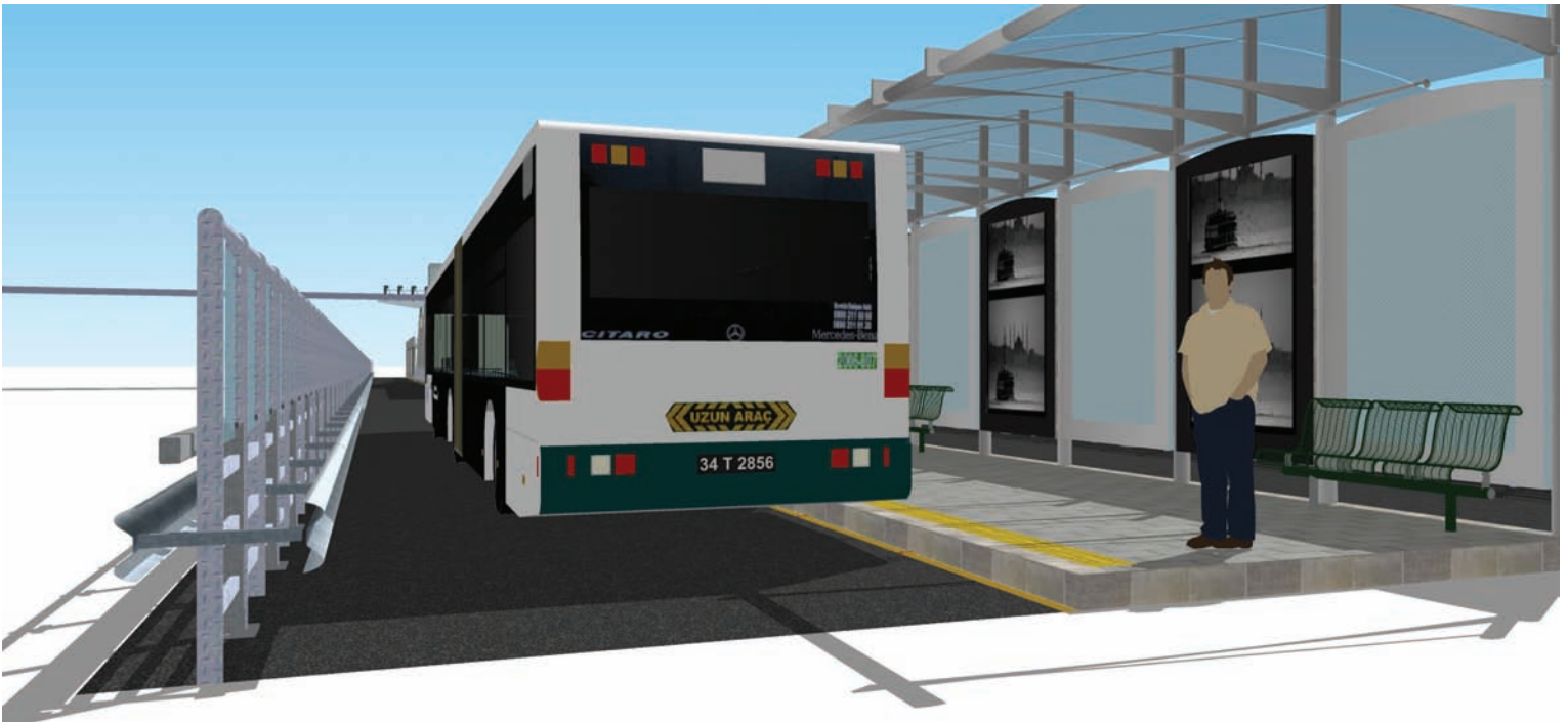
Hình 68 Biện pháp thiết kế minh họa sự kết hợp rào chắn kép và một lan can cao, được khuyến cáo sử dụng cho các BRT chạy trên đường cao tốc.
